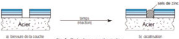
Fig. 1 : Protection par galvanisation Phénomène de cicatrisation
