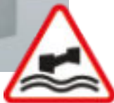
La pièce peut flotter au contact du bain de zinc
