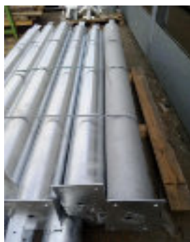
Différences de teintes liées à une composition chimique non-identique de l'acier
