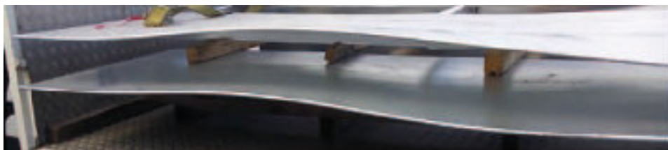
Ondulation d'une tôle soudée à un cadre
